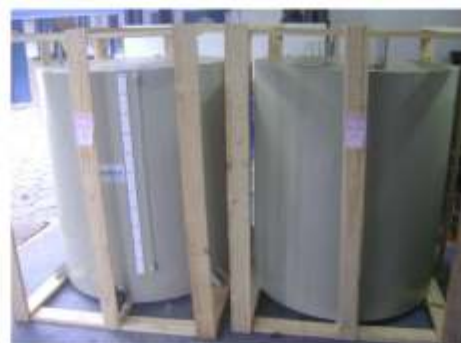
Reforma do dique de contenção do tanque de ácido clorídrico da ETE; e adquiridos dois novos tanques de polipropileno para preparo e dosagem do produto
