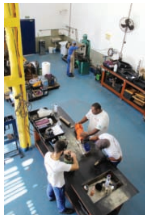
Manutenção preventiva em bombas de instalações de saneamento na Oficina Eletromecânica
